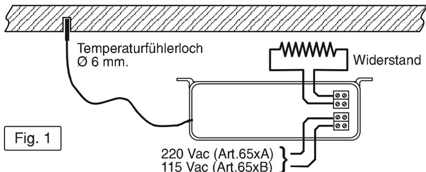
Die Anschlüsse müssen unter Beachtung des in Abb. 1 angegebenen Schaltplanes von Fachpersonal ausgeführt werden. Der Heizwiderstand sollte eine Höchstleistung von 2200 Watt bei einer Stromversorgung mit 220 V Ws (Art. 65xA) und 1150 Watt bei einer Stromversorgung mit 115 V Ws (Art. 65xB) haben. Apparatur der Klasse II.
